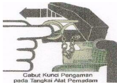
Gambar 15. Melepaskan kunci pengaman pada alat pemadam portabel
