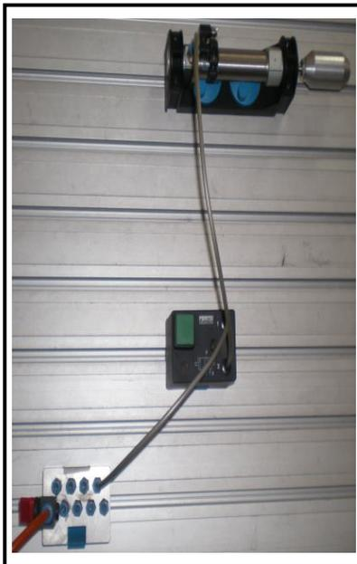
Gambar 3.2. Diagram rangkaian pneumatik untuk pengendalian silinder pneumatik kerja tunggal secara langsung oleh sebuah *Push Button* (PB)
