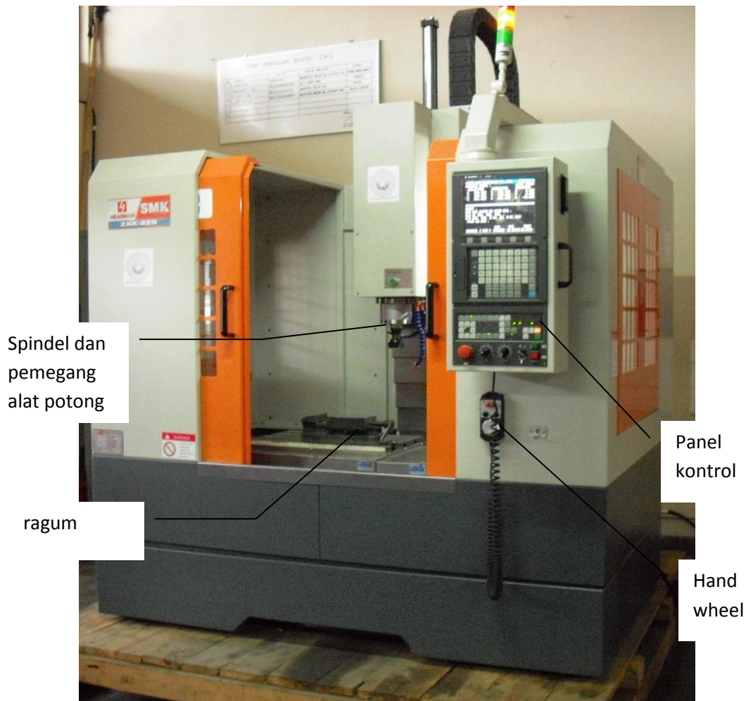
Gambar 1.2. Mesin frais CNC tanpa magazine , untuk penggantian alat potong dilakukan secara manual.
