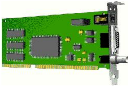
Gambar 2.19. Network Interface card (dari atas ke bawah konektor RJ-45, konektor AUI, dan konektor BNC)
