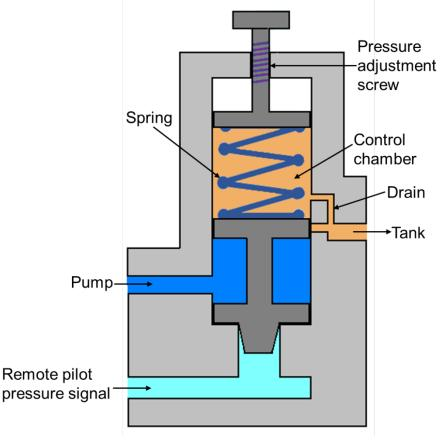
Figure 5.6.2 Unloading Valve
