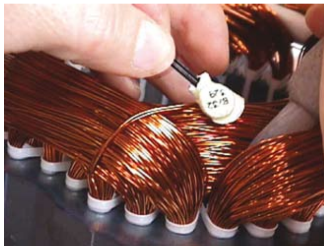
Figura 5.5 - Instalação do termostato na cabeça da bobina
