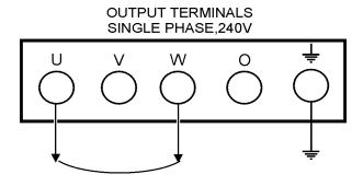
Figure 28. Hard Wire Hookup for Single Phase 240 volt
