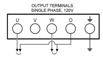
Figure 29. Hard Wire Hookup for Single Phase, 120 volt
