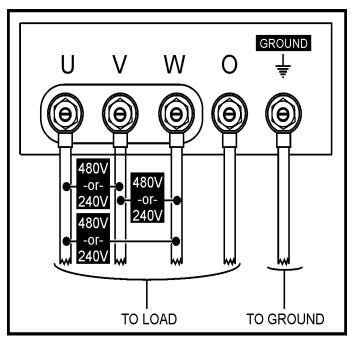
FIGURE 18. Hard Wire Hookup For 240V or 480V
