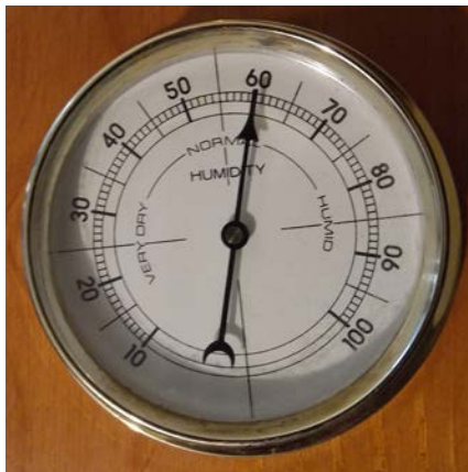
Figura 4.5 Higrómetro de absorción
