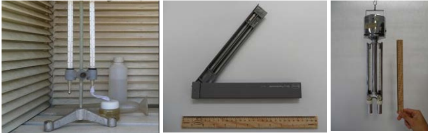
Figura 4.4.b Psicrómetros de ventilación
