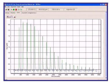
Figure 2 Incremental titrations.
