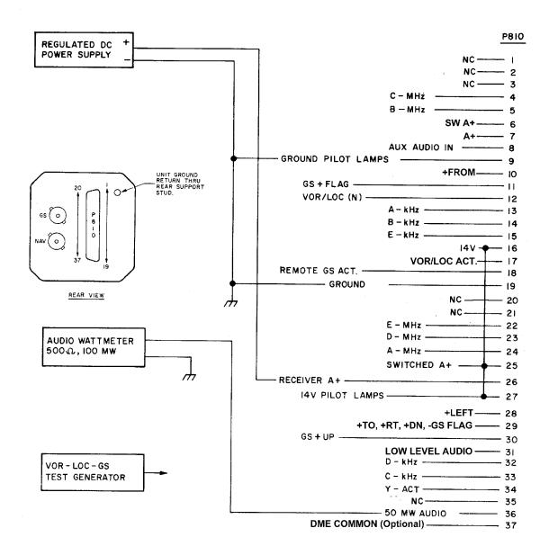
FIGURE 2-1. BENCH TEST HARNESS
