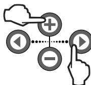
Cuando la interfaz del programador haya sido completamente programada, pulse simultáneamente los botones **+** y flecha a la derecha durante cinco (5) segundos para guardar los valores predeterminados por el instalador. Todos los iconos programados se encenderán intermitentemente al unísono para indicar que se ha guardado el programa.
