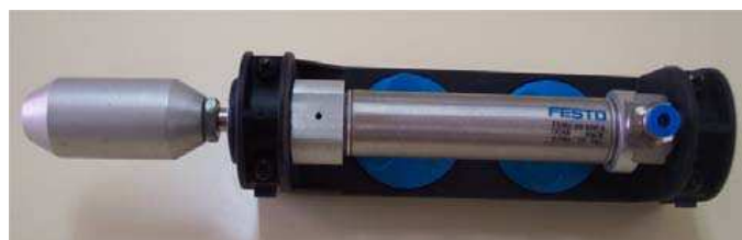
Foto de un cilindro de simple efecto con retorno por muelle.
