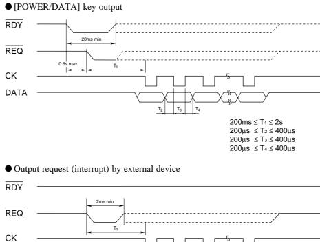
$T_1$   $T_2$   $T_2$   $T_3$   $T_4$   $T_2$   $T_3$   $T_4$   $T_2 \le T_1 \le 2s$   $200\mu s \le T_2 \le 400\mu s$   $200\mu s \le T_3 \le 400\mu s$  $200\mu s \le T_4 \le 400\mu s$
