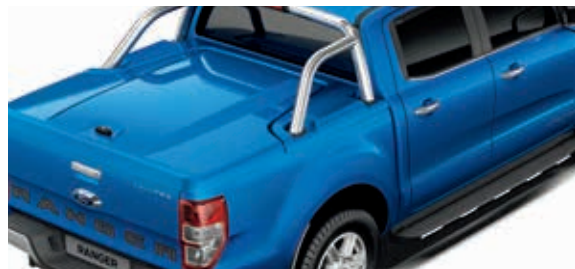
Twarda pokrywa skrzyni ładunkowej z tworzywa
