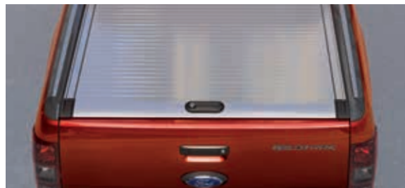
Aluminiowa roleta skrzyni ładunkowej, zamykana na klucz
