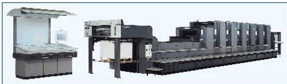
3-4. ábra Korszerű íves ofset nyomógépsor [1]
