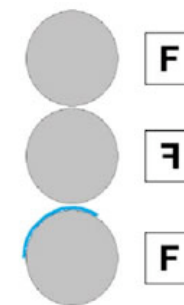
Figura 5: Esquema de la impresión indirecta de la máquina offset (esquema de Ira Rubel)
