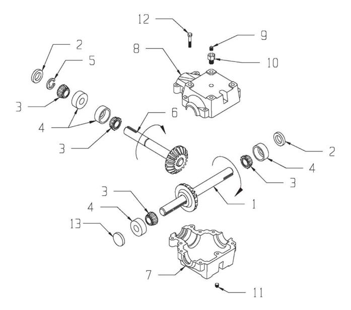
Use 80W90 Gear Lube Oil  $\underline{\textbf{ONLY}}.$   $\underline{\textbf{DO NOT}}$  USE GREASE FOR LUBRICANT.
