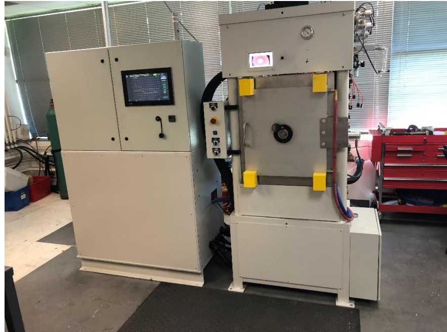
Thermal Technologies 2600C, 100 Ton Hot Press
