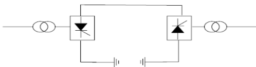
Fig. 2. Monopolar HVDC configuration [1].
