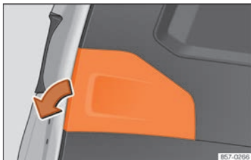
Fig. 116 Rear lid open: remove the lid.
