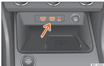
Fig. 236 Centre console: USB/AUX-IN input.
