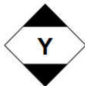
Obr. 2 Označenie kusovej zásielky obsahujúce nebezpečné veci odovzdávané na prepravu leteckou dopravou v zhode s ustanoveniami časti 3, kapitoly 4 v ICAO Technické inštrukcie pre nebezpečnú leteckú prepravu nebezpečných vecí 8
