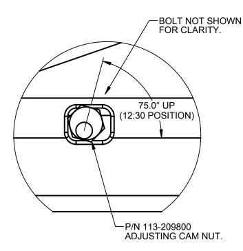
DETAIL OF ADJUSTING NUT (POSITION OF ADJUSTING CAM NUT SHOWN IS FOR MAXIMUM ATTACK ANGLE)
