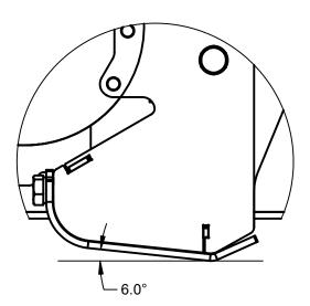
END VIEW OF EXTENSION BOTTOM (ATTACK ANGLE SHOWN IS MAXIMUM)
