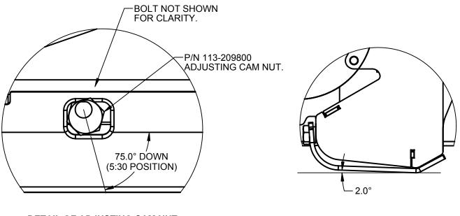
DETAIL OF ADJUSTING CAM NUT (POSITION OF ADJUSTING CAM NUT SHOWN IS FOR MINIMUM ATTACK ANGLE)
