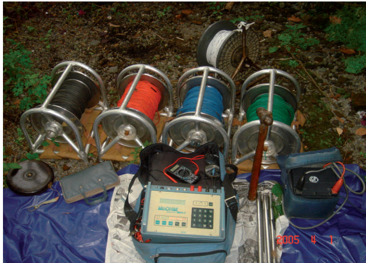
Gambar (3) : Peralatan yang digunakan pada metode geolistrik sounding, Resistivitymeter OYO Model 2115 McOhm
