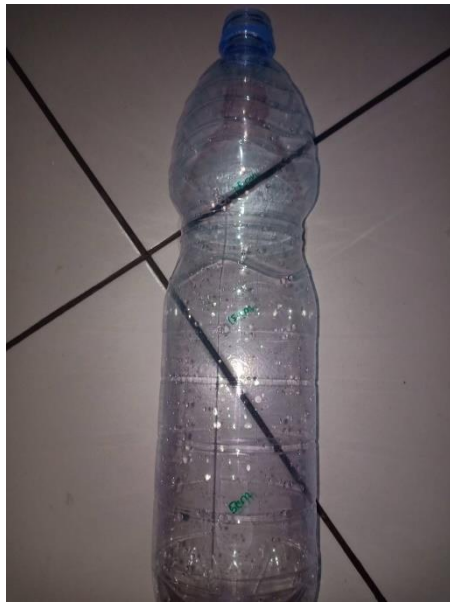
3.3 Botol plastik dilubangi dengan paku yang dipanaskan
