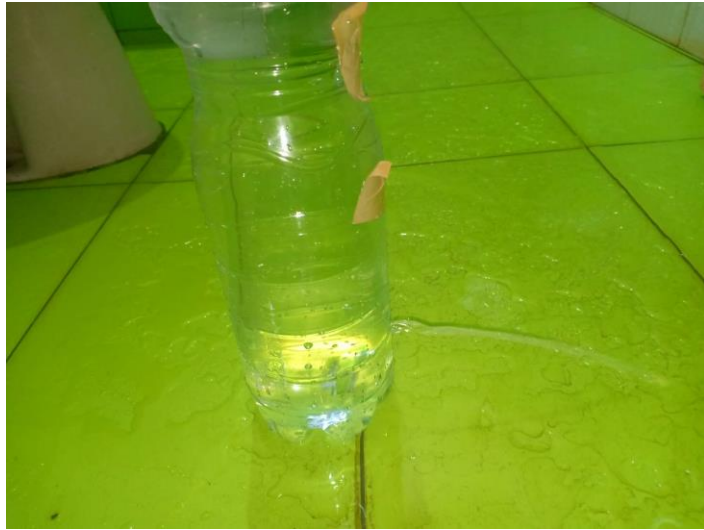
3.9 Air yang keluar dari ketinggian 5cm
