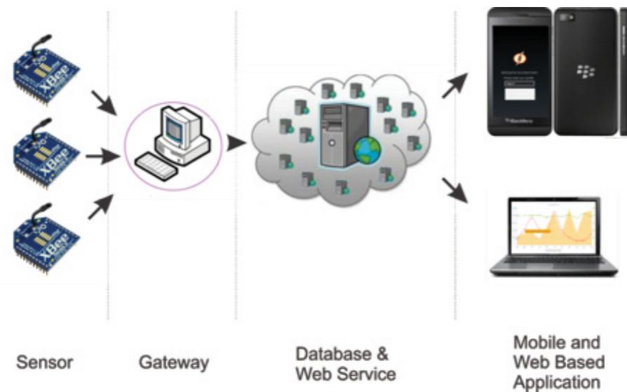
Gambar 13. Komunikasi Wireless Sensor pada Sistem Metering (sumber: http://takamulsystems.com )
