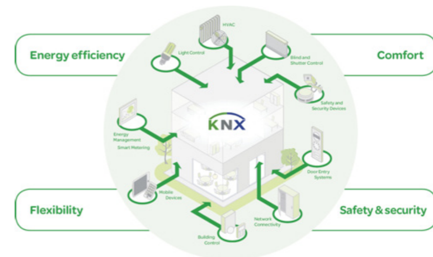
Gambar 12. Building Automation dari KNX (sumber: http://takamulsystems.com )
