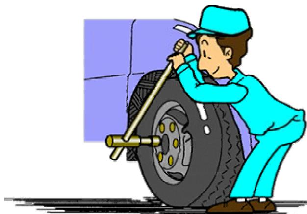
Gambar 30. Pasang Kunci Roda pada Mur Roda
