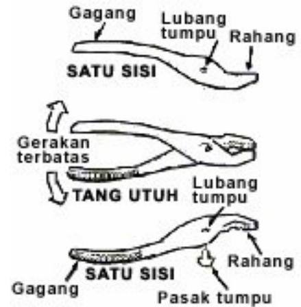
Gambar 64. Konstruksi Tang
