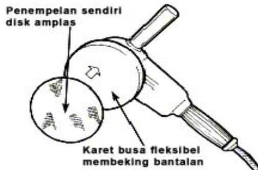
Gambar 146. Penggantian disk Mesin Pengampelas (bantalan lunak)
