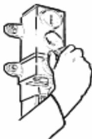
*Gambar 174. Putar knob regulator untuk mengatur tekanan udara*
