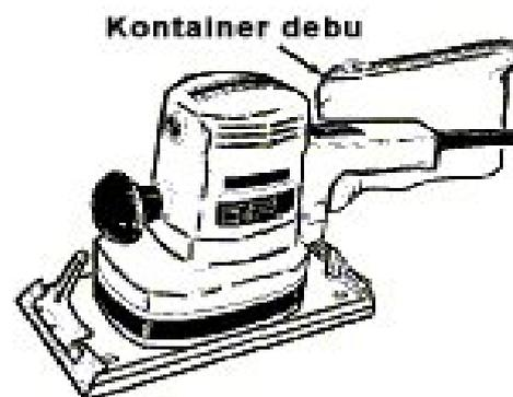
Gambar 140. Sistem penyedot debu vakum
