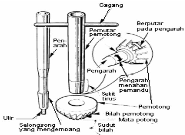
Gambar 56. Pemotong Dudukan Katup
