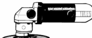
*Gambar 151. Sander/Mesin Pengampelas cakram orbital listrik*
