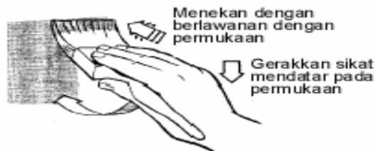
Gambar 128. Pegang kuas dalam posisi menyudut
