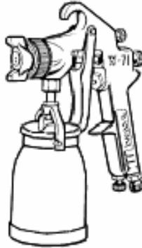
*Gambar 164. Alat penyemprot jenis penyedotan*
