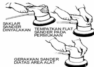
*Gambar 152. Penggunaan Mesin Pengampelas cakram orbital*
