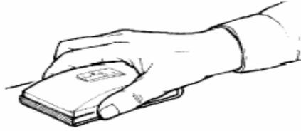
*Gambar 133. Pegang landasan rata dengan permukaan*
