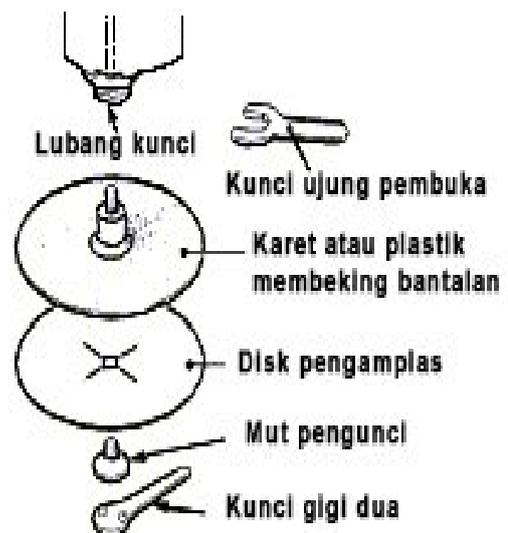
Gambar 145. Bagian-bagian cakram Sander/Mesin Pengampelas (bantalan keras). Gunakan kunci pas cakram untuk membuka
