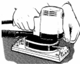
*Gambar 156. Pegang Mesin Pengampelas orbital kuat-kuat dengan kedua tangan saat mengoperasikannya*
