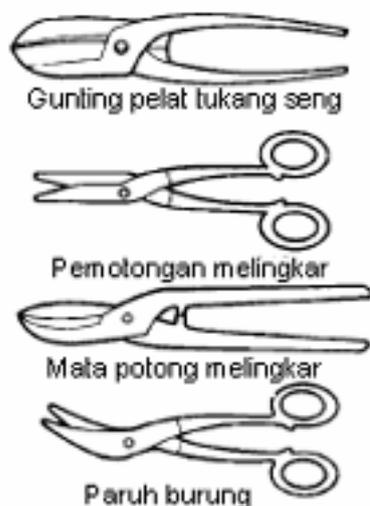
*Gambar 107. Gunting pelat untuk memotong bentuk setengah lingkaran*
