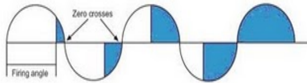
Gambar 2.8 Bentuk Keluaran Gelombang
