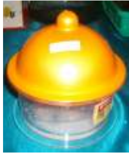
Gambar 8. Desikator berisi larutan garam jenuh untuk percobaan penentuan isotermi sorpsi air bahan.
