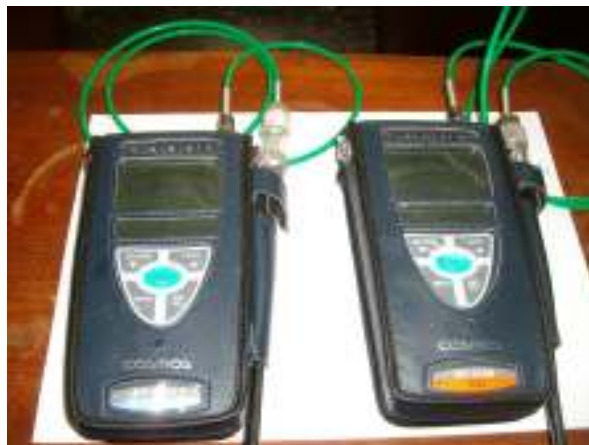
Gambar 1. Cosmotector Tipe XP 314 dan XPO-318 untuk mengukur konsentrasi O 2 dan CO 2
