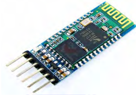
Gambar 2.4 Bentuk Fisik Modul Bluetooth HC-05 (Sumber : Ratna Dewi, Ramiati ; 2011 : 48)
