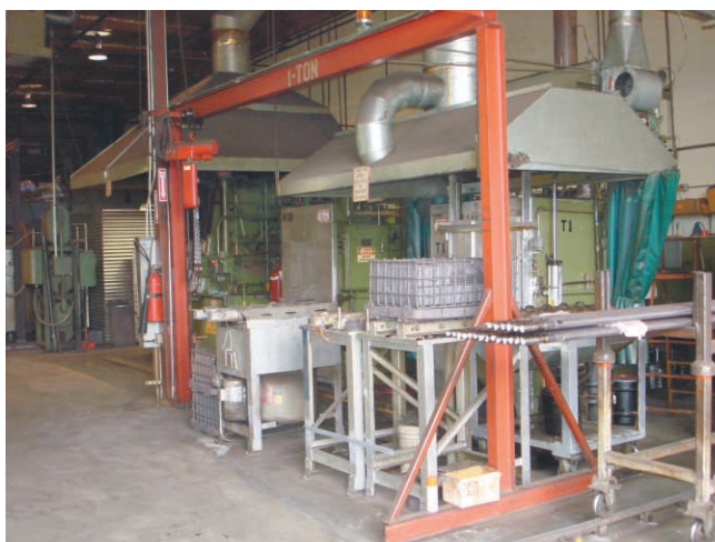
Figura 6.- Antes de pasar a las últimas etapas, las piezas pasan por los hornos para su tratamiento térmico.
