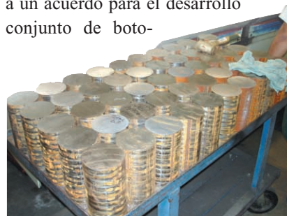
Figura 5.- El primer paso en la fabricación de las bocas comienza en el corte de la barra de acero.
