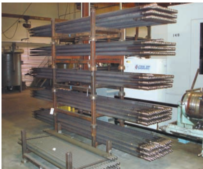
Figura 9.- Las barras fabricadas en Estados Unidos son todas sometidas a tratamientos de alta frecuencia.
