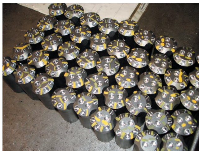
Figura 7.- Las bocas ya fabricadas esperan su entrada en el horno de dilatación para el insertado de los botones.
