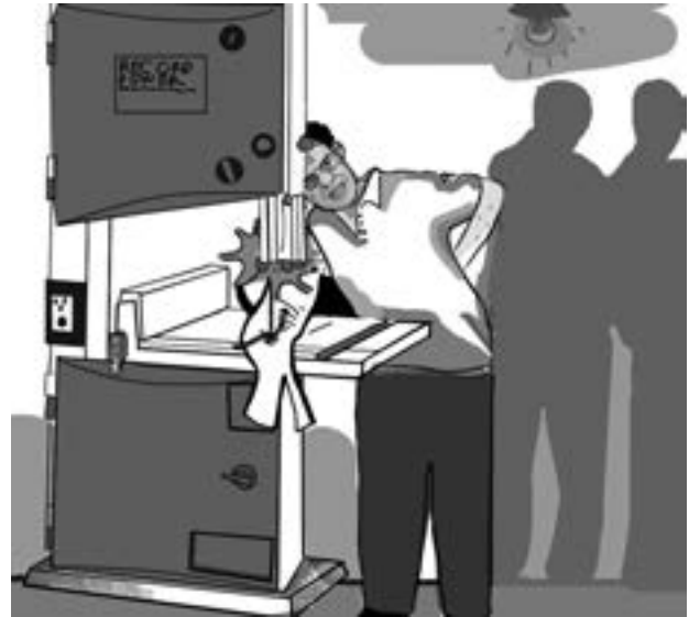
2 - Les machines non protégées peuvent augmenter l'exposition de ses parties mobiles et accroître le risque d'accidents.
