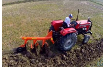
Labour à la charrue à socs ou à disques
