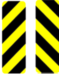
Gambar 4.16 Rambu Peringatan Rintangan untuk Objek Berbahaya pada Sisi Jalan
