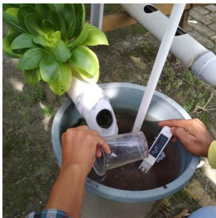
Gambar 7. Pengukuran kandungan nutrisi dengan pH meter
