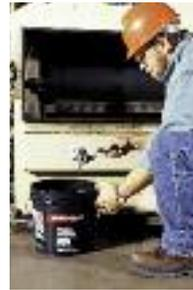
El Wearing Compound es mezclado y aplicado fácilmente sobre superficies irregulares para reparar metal dañado por desgaste y abrasión.
