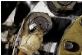
Al aplicar el N-5000 High Purity Anti-Seize a los pernos antes de ensamblarlos permite un fácil ensamblado de piezas y evita las raspaduras y el aferramiento.
