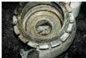
Con el Wearing Compound se prolonga la vida útil de una bomba de cenizas de fondo.
