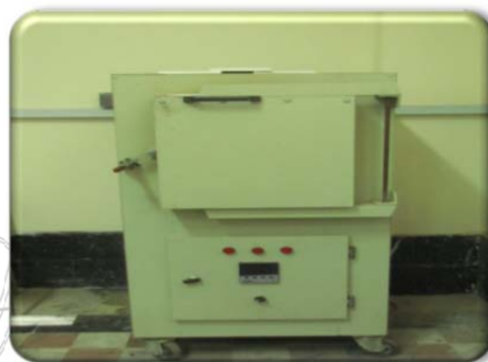
نام دستگاه: کوره سفال Electric Pottery Kiln کارگاه: سفال کارخانه سازنده: صنعت سران مدل: اختصاصی دست ساز کاربرد: پخت لعاب
