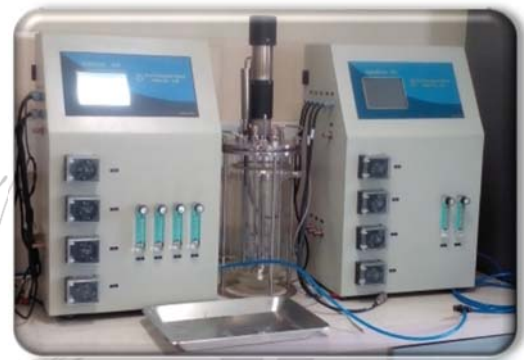
نام دستگاه: فرماتور Lab Fermenter آزمایشگاه: بیوتکنولوژی کارخانه سازنده: ایران پنام کاربرد: راکتور تخمیری
