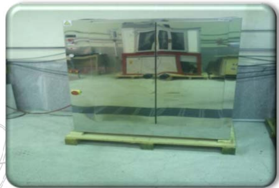
نام دستگاه: محفظه گرم کن (اون) آزمایشگاه: آزمایشگاه تحقیقاتی روسازی کارخانه سازنده: شرکت بقایی سنگسری و برادران مدل: IPC کاربرد: گرم کننده مصالح و نمونه های آسفالتی
