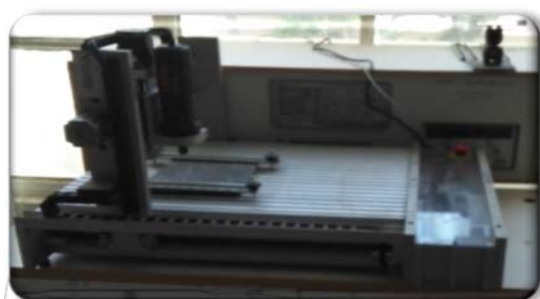
نام دستگاه: دستگاه ربات با دو درجه آزادی آزمایشگاه: ربات کارخانه سازنده: yildirim elektronik ترکیه مدل: GGS 27C کاربرد: آموزش مکانیزم های فضایی
