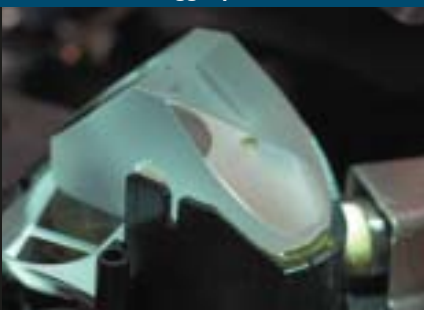
Sistema montaggio prismi elastico
