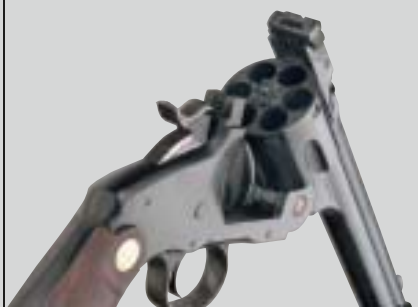
Laramie - Canna basculante e chiusura superiore (top break)
