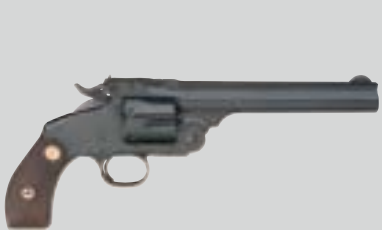
Laramie - Canna basculante e chiusura superiore (top break)
