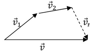
La somme de n vecteurs :  $\vec{v}_1, \vec{v}_2, \dots, \vec{v}_n$  est un vecteur  $\vec{v}$  tel que :  $\vec{v} = \vec{v}_1 + \vec{v}_2 + \dots + \vec{v}_n$
