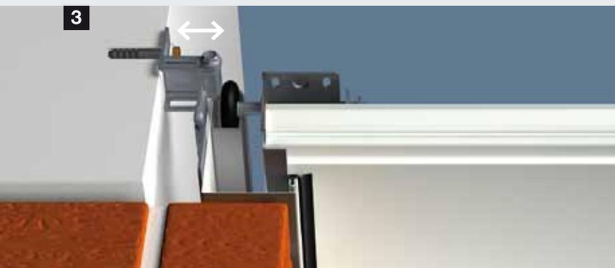
**3** Montage en cas de façade non porteuse (briques ou isolation thermique) avec écoinçon latéral de min. 90 mm à max. 125 mm
