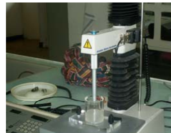
Figure 2 : Back-extrusion d'un gel d'amidon au TAXT2i
