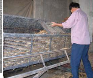
Photo 2 : laveuse de type cage hexagonale (Vietnam)
