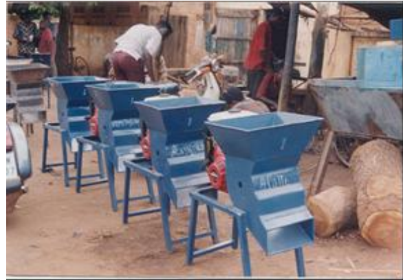
Figure. 4 : Production en série du prototype réduit de la râpe motorisée par les ferrailleurs et ajusteurs-tourneurs.
