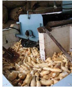
Photo 4 : Laveuse en continu, vue côté sortie (Colombie)
