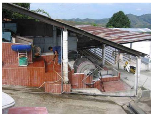
Fig. 5 : Utilisation de la gravité dans les unités de production d'amidon aigre en Colombie.
