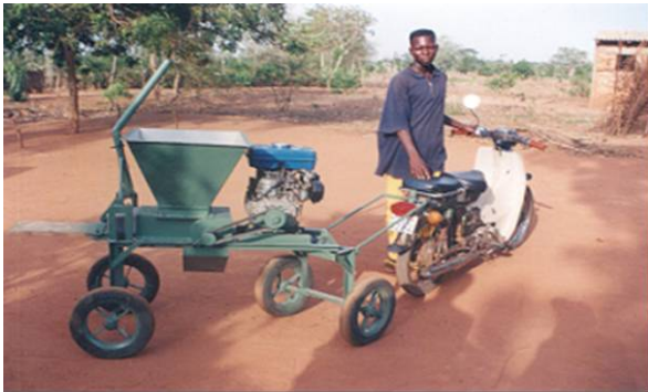
Figure. 2 : La râpe motorisée sur roues
