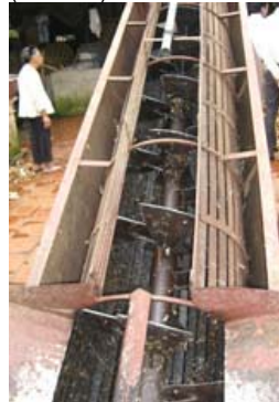
Photo 3 : Laveuse en continu avec arbre et vis sans fin (Vietnam)
