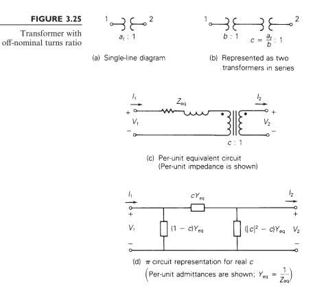
$\begin{bmatrix} I_1 \\ -I_2 \end{bmatrix} = \begin{bmatrix} Y_{11} & Y_{12} \\ Y_{21} & Y_{22} \end{bmatrix} \begin{bmatrix} V_1 \\ V_2 \end{bmatrix}$ (3.8.4)
