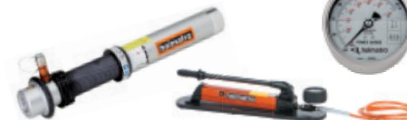
Los puntales hidráulicos funcionan por medio de una bomba hidráulica manual con manguera y manómetro de presión de hasta 720 bares. Este manómetro indica claramente la presión máxima permitida según la longitud del apuntalamiento. Capacidad de carga y elevación: 100 kN / 10,2 t
