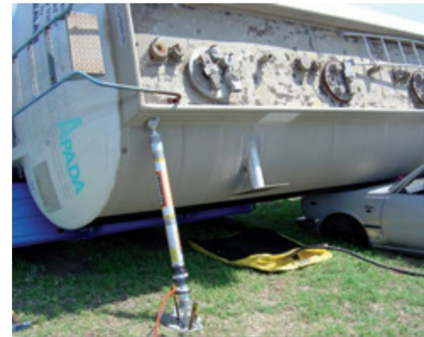
Puntal neumático autoblocante utilizado como apuntalamiento de seguimiento en operaciones de elevación de un vehículo pesado.
