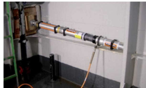
Puntal hidráulico, con extensiones, cabezales y madera, sellando una fuga en el interior de un barco de la Marina
