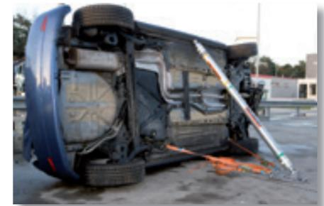
Placa base, extensiones y cabezales utilizados en la estabilización de un vehículo ligero.
