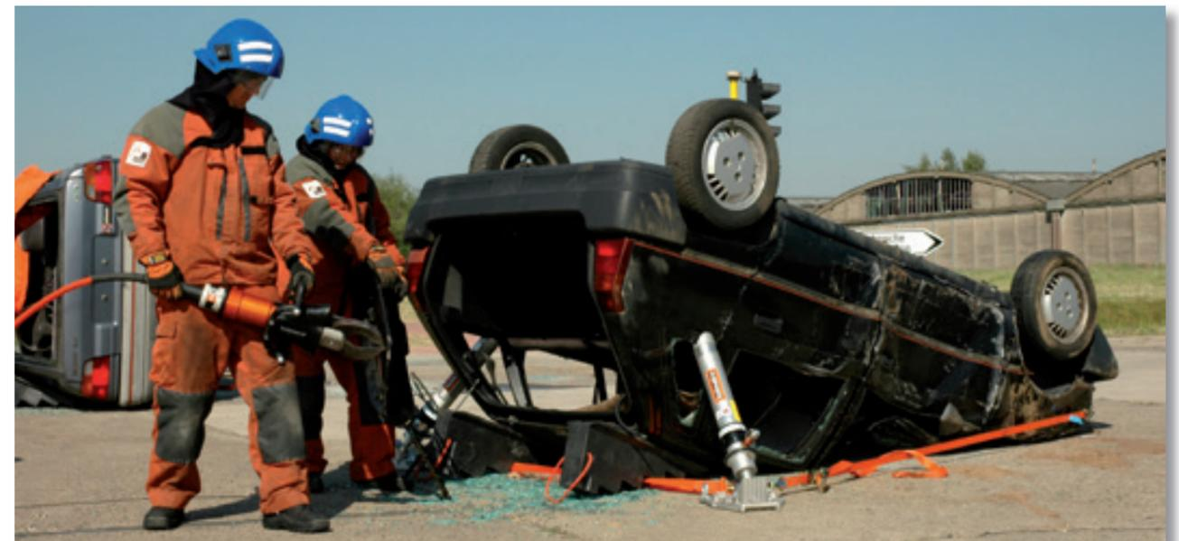
Dos puntales hidráulicos utilizados en la estabilización de un vehículo ligero y, si fuera necesario, para una elevación controlada.
