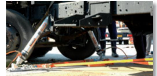
Estabilización de vehículo pesado con puntal hidráulico con contratuerca.
