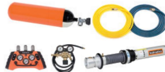
Los puntales neumáticos funcionan por medio de un sistema neumático a 8 bar de presión que consiste en una botella de aire comprimido, un reductor de presión, una unidad de control y mangueras. Capacidad de carga: 100 kN / 10,2 t. Capacidad de elevación: 4,0 kN / 0,4 t
