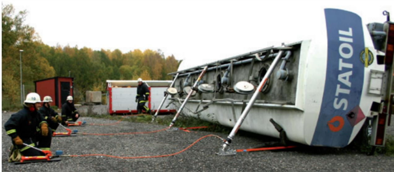
Apuntalamiento y elevación de un vehículo pesado con un sistema hidráulico PowerShore™.
