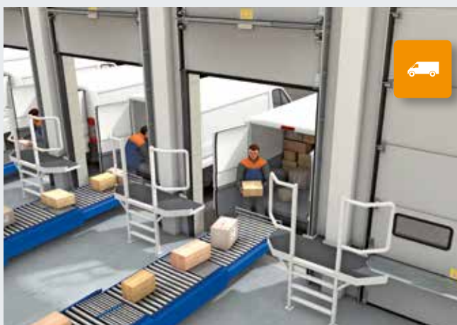
Dodávková vozidla se nakládají na úrovni podlahy haly. K tomuto účelu se vrata kompletně otevřou včetně lamelového podstavce.
