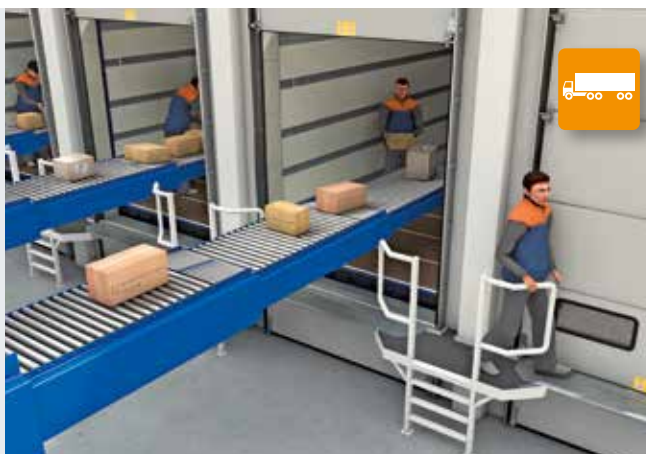
Při nakládce na nákladní vozidla a výměnné můstky zůstává lamelový podstavec s obslužnou lávkou při otevřených vratach na podlaze.
