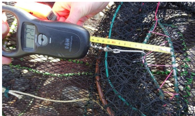
Abb.: Öffnungsweite der Gummireißnaht bei unterschiedlichen Zuggewichten
