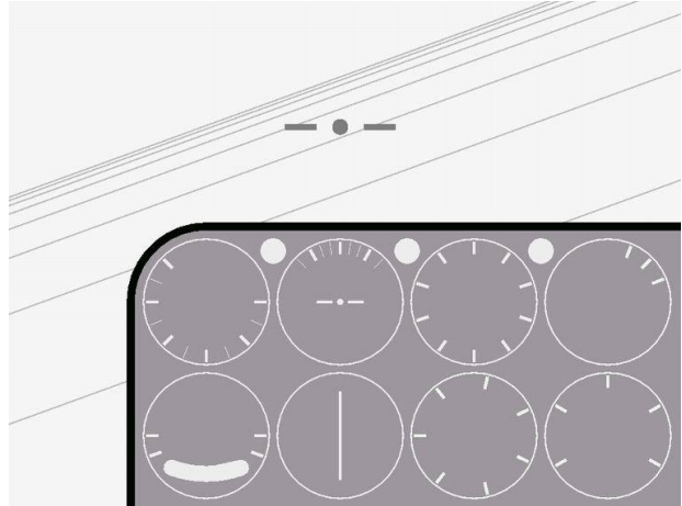
Assiette de descente et inclinaison à droite
