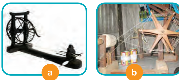
Gambar 1.34 Mesin yang dapat digunakan untuk mengolah serat hewan a. mesin pemintalan, b. Mesin penggulung benang hasil pemintalan.
