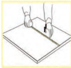
a. Ukuran kaca yang akan dipotong ini disesuaikan dengan bentuk akuarium yang akan dibuat. Dalam membuat potongan potongan kaca, lembaran kaca dibuat polanya terlebih dahulu dengan menggunakan spidol dan penggaris besi. Pola yang sudah dibentuk dapat langsung dipotong.
