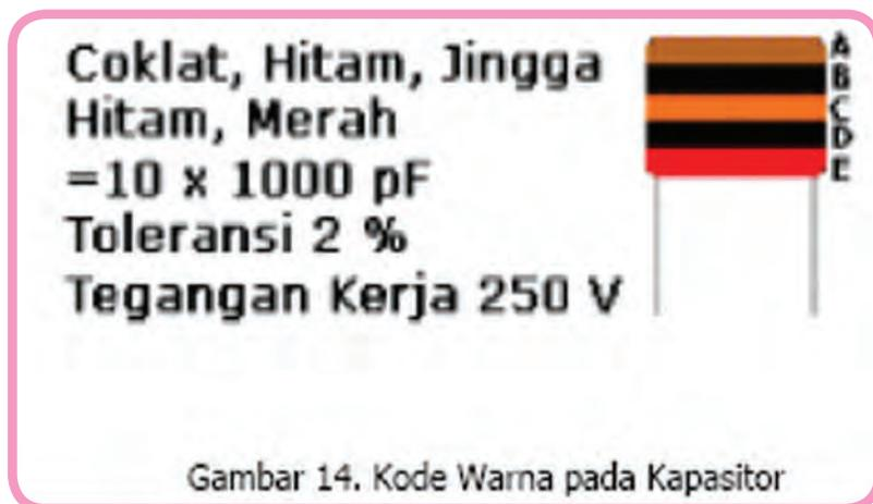
Gambar 14. Kode Warna pada Kapasitor
