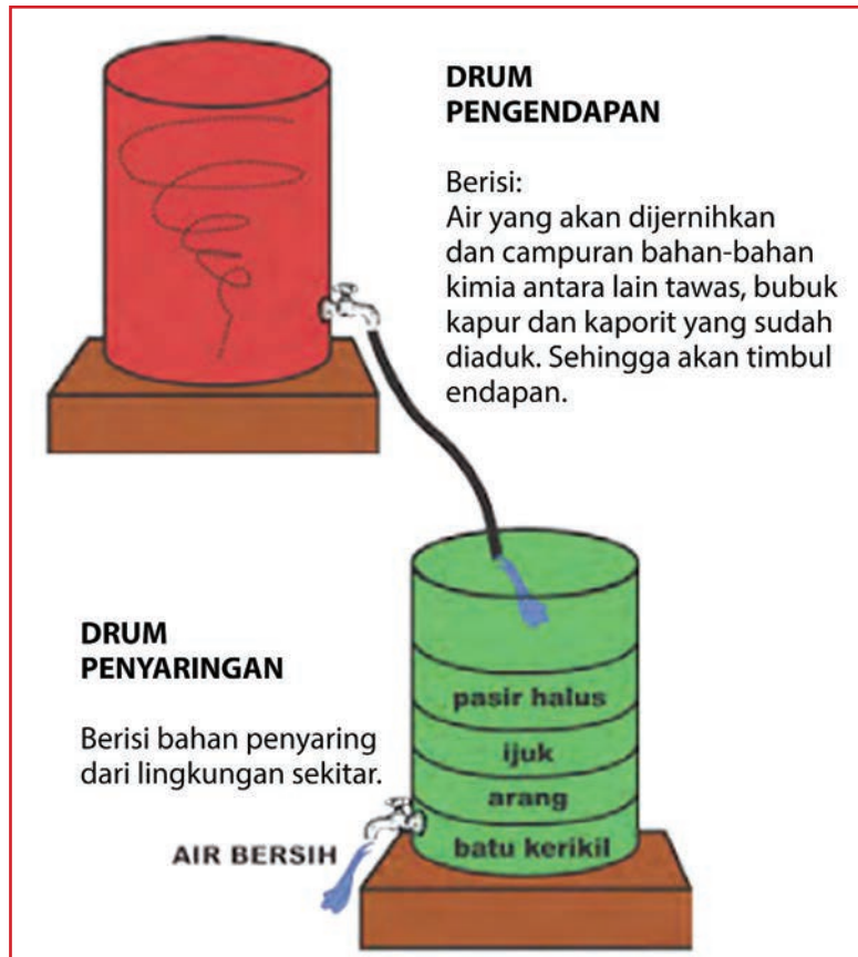
Sumber: Dokumen Kemdikbud Gambar 2.11. Drum penyaring dan drum pengendapan
