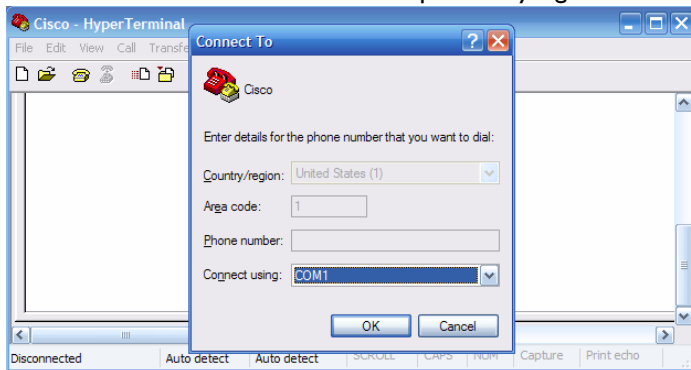
Gambar 8.7 Konfigurasi Parameter Pilih COM1 atau koneksi yang sesuai dengan keadaan.
