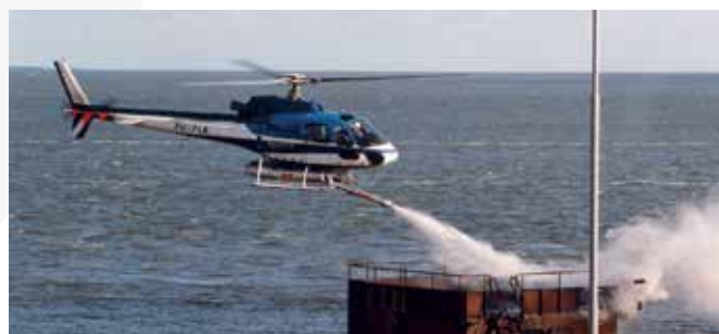
Helicóptero IFEX® en servicio de extinción (Intruder doble de 2x18 litros)
