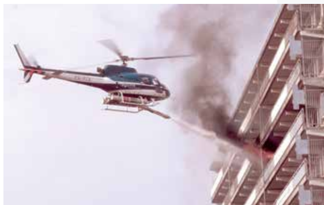
Sistema de extinción IFEX® en uso durante un incendio en un edificio elevado
